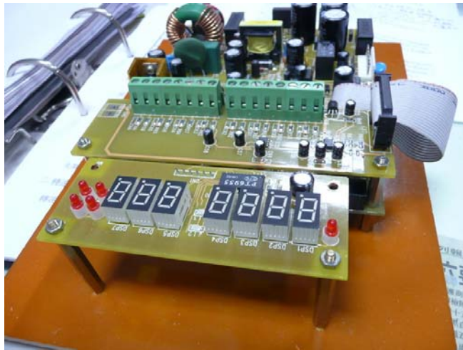
圖 7、控制板上有 USB Device 界面可以與 PC 溝通外，還有壓縮機啟動與電子膨脹閥的驅動電路
