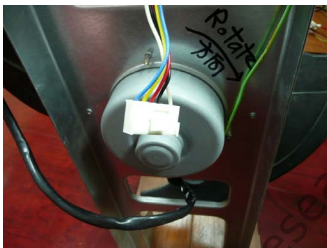
圖 4、冷氣排熱扇的電源與信號接頭 (含馬達電源、轉速設定與轉速回授信號)
